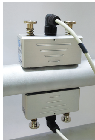
2개의 QE1008 센서를 장착하여 밴딩을 보상하여 측정
